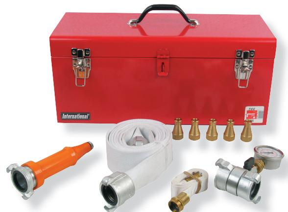
Este kit para ensayo de bomba incluye lo necesario para controlar el rendimiento de las bombas de alta presión. El kit contiene 5 boquillas calibradas, una lanza chorro pleno, tramo corto de manguera de 19 mm (3/4") y de 38 mm (1 1/2"), manómetro y caja de herramientas.
